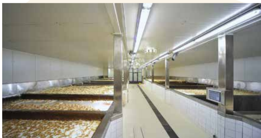
Kvašení v otevřených spilkách se už dnes ve větších pivovarech moc nevidí; v zájmu urychlení výroby a snížení nákladů většina průmyslových pivovarů využívá uzavřené nerezové cylindronické tanky, v nichž pivo kvasí působením jiných tlaků a teplot rychleji.
